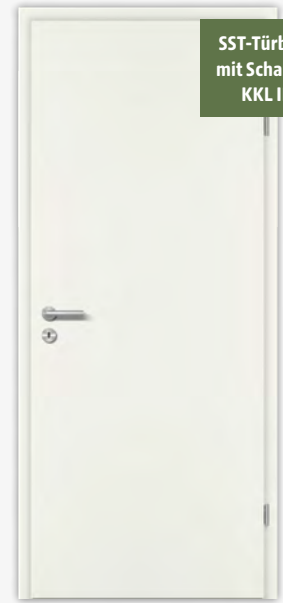
Schallschutz-Türblatt (SST) Schallschutz (SD32 = Rw, P 32 dB) Klimaklasse III, inkl. Schall-Ex, Bänder V0026, PZ vorbereitet
