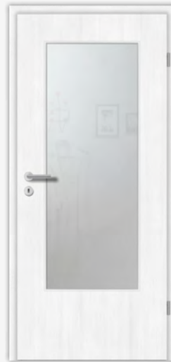
Türblatt CPL Touch Pearlline mit kl. Rundkante (KR), Röhrenspanplatte (RSP), mit Lichtausschnitt (DIN-LA)
