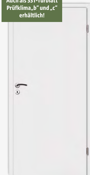
Schallschutz-Türblatt (SST) Weisslack mit Rundkante (RU) Schallschutz (Rwp 32dB) Prüfklima b+c inkl. Bodendichtung 3-tlg. Bänder, vern., PZ-vorgerichtet
