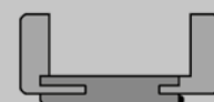
Zarge mit Schließblech in Weiß, Verstellbereich -5/+15 mm, Designkante, Futterplatte mit kl. Rundkante (60 mm)
