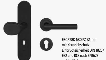
ESGR28 680 PZ 72 mm Einbruchsicherheit DIN 18257 ES2 und RC3 nach EN 1627 rechts / links verwendbar In Kosmos Schwarz oder Edelstahl matt erhältlich
